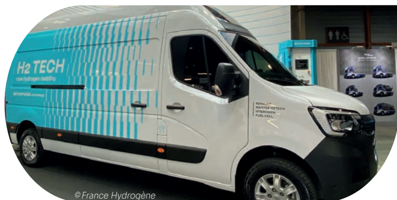
© France Hydrogène Le Master Van H 2 -TECH est équipé d'une pile à combustible de 30 kW, d'une batterie de 33 kWh et de réservoirs contenant 6 kg d'hydrogène (4 réservoirs de 1,5 kg) pour une autonomie allant jusqu'à 500 km
